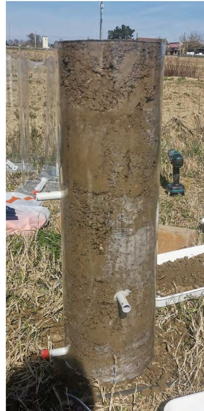
Le carote di suolo sono state ricomposte immediatamente dopo il prelievo, a partire dei singoli strati di 20 cm prelevati (0-20, 20-40, 40-60 cm), riposizionati nello stesso ordine in cilindri di plexiglass opportunamente attrezzati con tubi forati per il prelievo dell'acqua di percolazione a diversi orizzonti di profondità.
